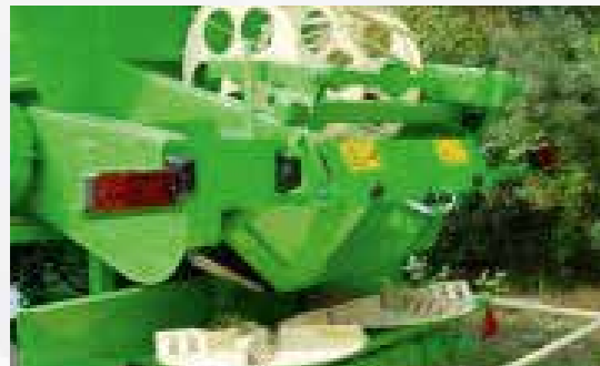
Streuscheiben mit 4 verstellbaren Leisten für z.B. Kalk, Trockenkot und Kompost
