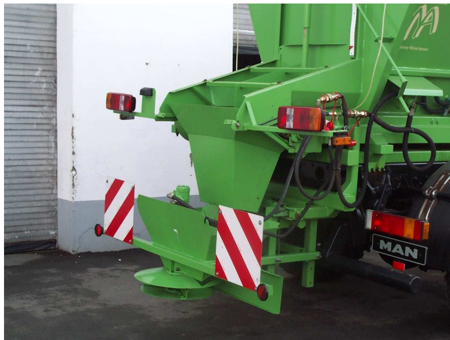
Механизм рассеивания для поддержания автодорог в зимний период
