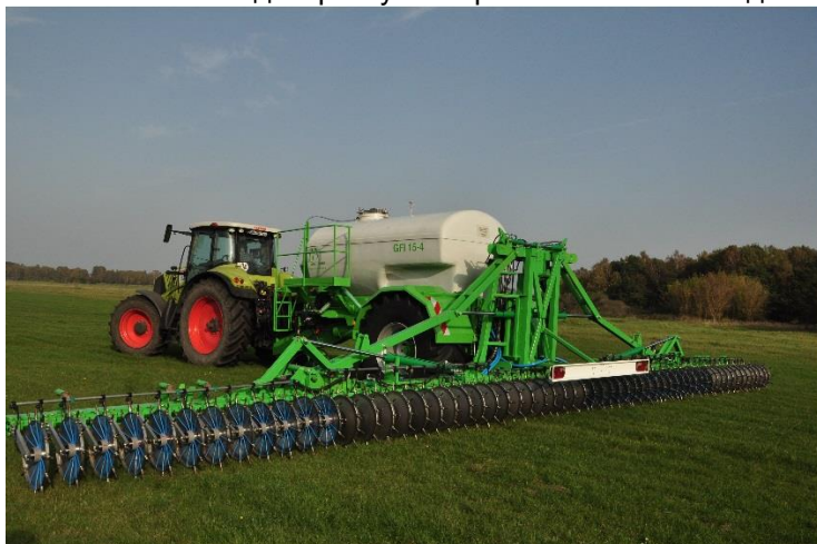
Складная рама в рабочем положении
