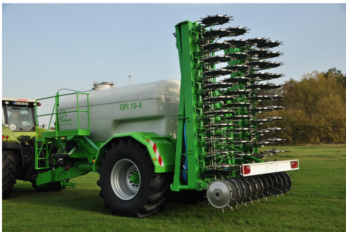
Разбрасыватель в транспортном положении
