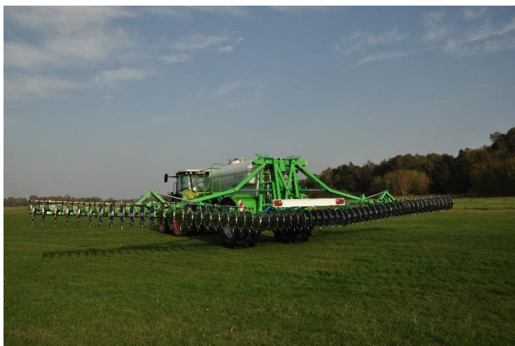
Складная рама в положении V
